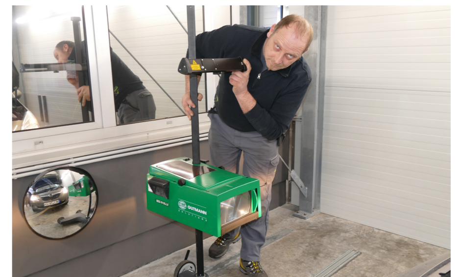
Moderne Lichtsysteme richtet Rückert im nivellierten Lichteinstellplatz korrekt aus.
