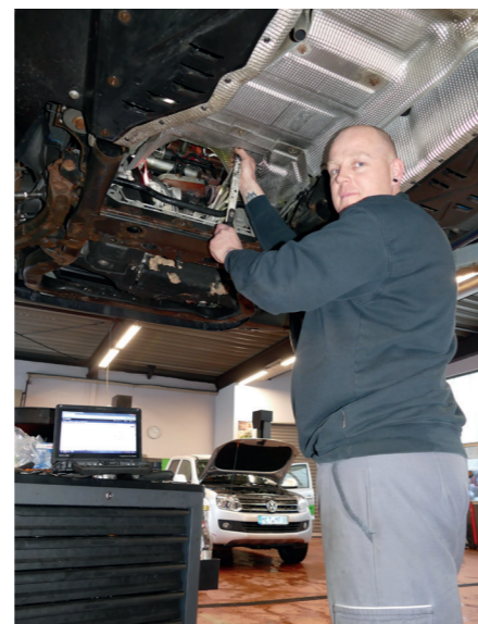
Notwendige Daten für den Tausch des defekten Turboladers bei einem VW T5 kann Kfz-Meister Daniel Kessler über die Plattform Alldata abfragen.
