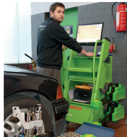
Unter Einsatz moderner Technik und Herstellerdaten vermisst Patrick Sitzmann Sturz und Spur des Autos.
